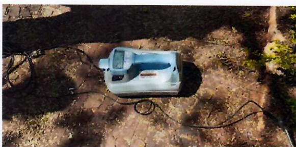
Foto 03. Equipamento que realiza a sondagem de interferências.
