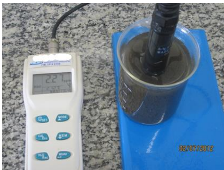
Foto 2: Aparelho para medição de oxigênio dissolvido pelo método eletrométrico.
